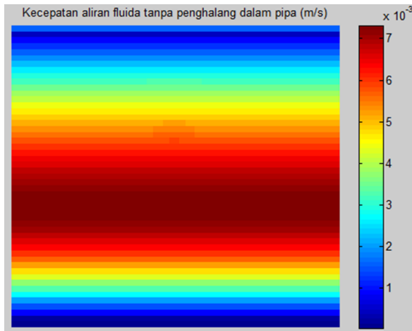
Gambar 3. Model kecepatan aliran fluida didalam pipa tanpa penghalang
