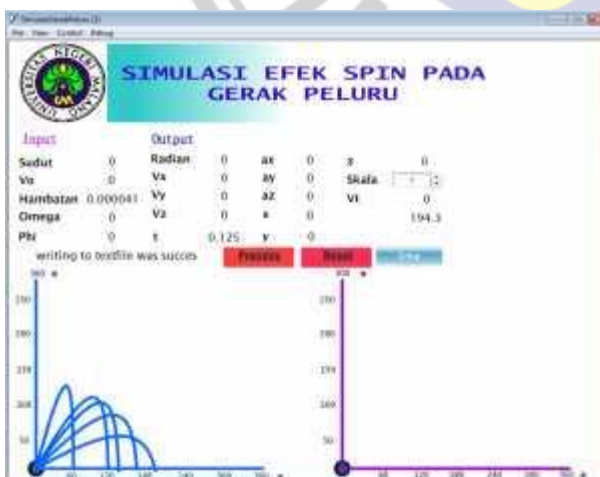
Gambar 6. simulasi saat sistem diset dengan hambatan variasi sudut sebesar 30, 45, 55, 60, 75 kecepatan sebesar 100, skala 1 dan \omega = 0
