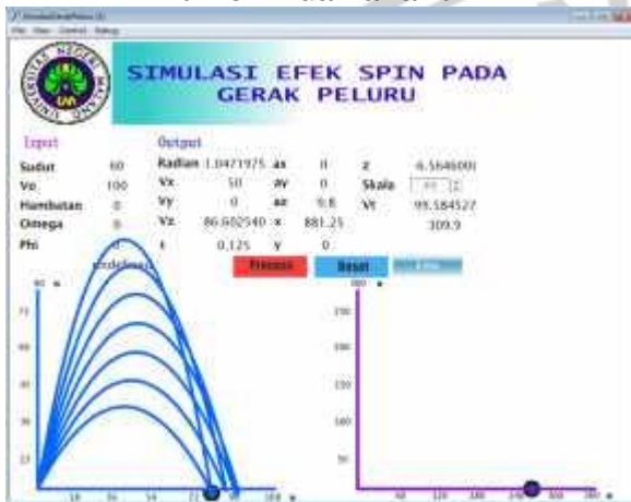
Gambar 5. Simulasi saat sistem diset tanpa hambatan variasi sudut sebesar 30, 35, 40, 45, 50, 55, 60, kecepatan sebesar 100, skala 0.4 dan \omega = 0
