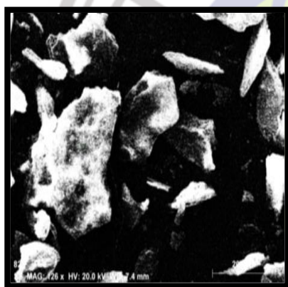
Gambar 7. Hasil SEM serbuk buah tomat pada suhu 170°C
