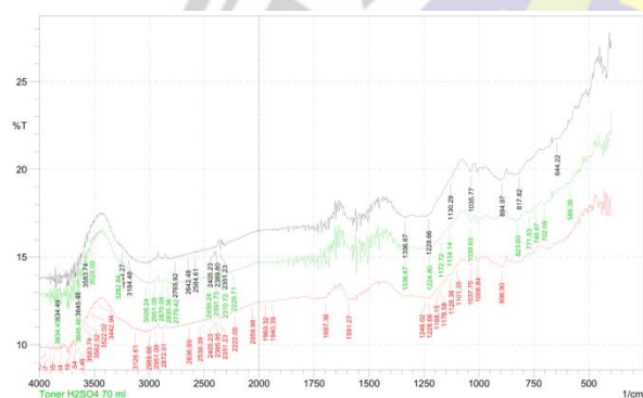
Gambar 5. Hasil Uji FTIR ( Fourier Transform Infra-Red ) Toner dengan Variasi Penambahan \text{H}_2\text{SO}_4 50 ml (hitam), 60 ml (merah) dan 70 ml (hijau)
