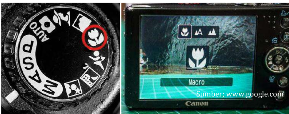
Gambar 6.4. Contoh Ilustrasi a. mode makro pada kamera DSLR, b. mode makro pada kamera pocket.
